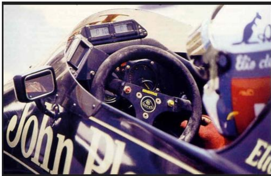
Pode-se ver o Computador de Bordo na Lotus de Elio De Angelis.
